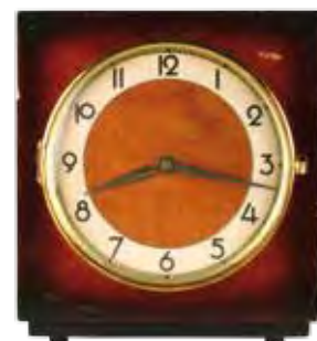
TAM-Meter. Gerät zur Messung des TV-Konsums. Infratam, Wetzlar, verwendet 1963-1974. (Inv. 2008-086)
